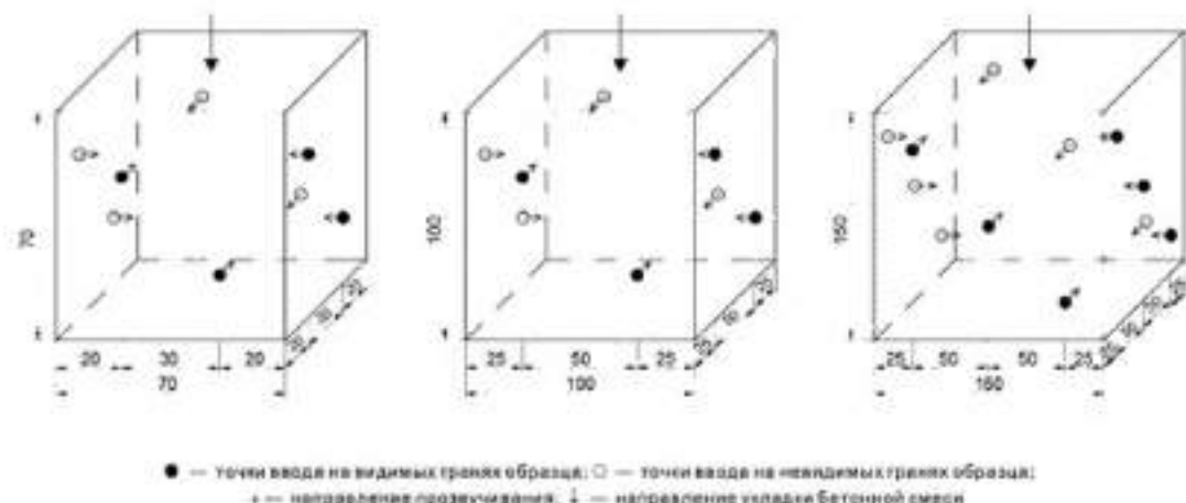
Рисунок 1 — Схема расположения точек ввода ультразвуковых колебаний
