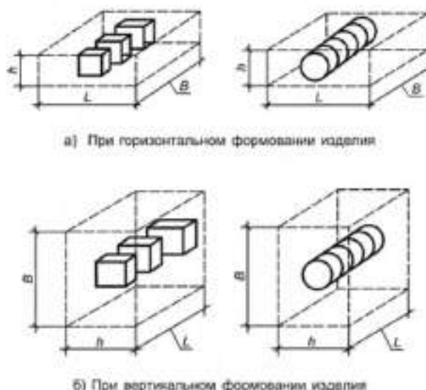
Рисунок 1 — Схемы выпиливания и выбурирования образцов ячеистого бетона
